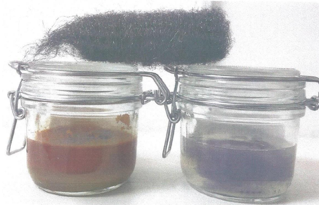
FOTO 4 : CORROSIE VAN ONBEHANDELD EN BEHANDELD STUK STAALWOL IN WATER
