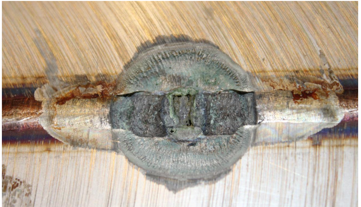
FOTO 3 : MIC VAN EEN ROESTVAST PLAATMATERIAAL 304
