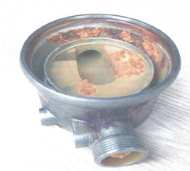
FOTO 2 : TUBERCULES IN HET VOETSTUK VAN EEN POMP
